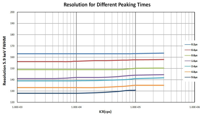
图2.分辨率VS输入计数率(不同达峰时间)
